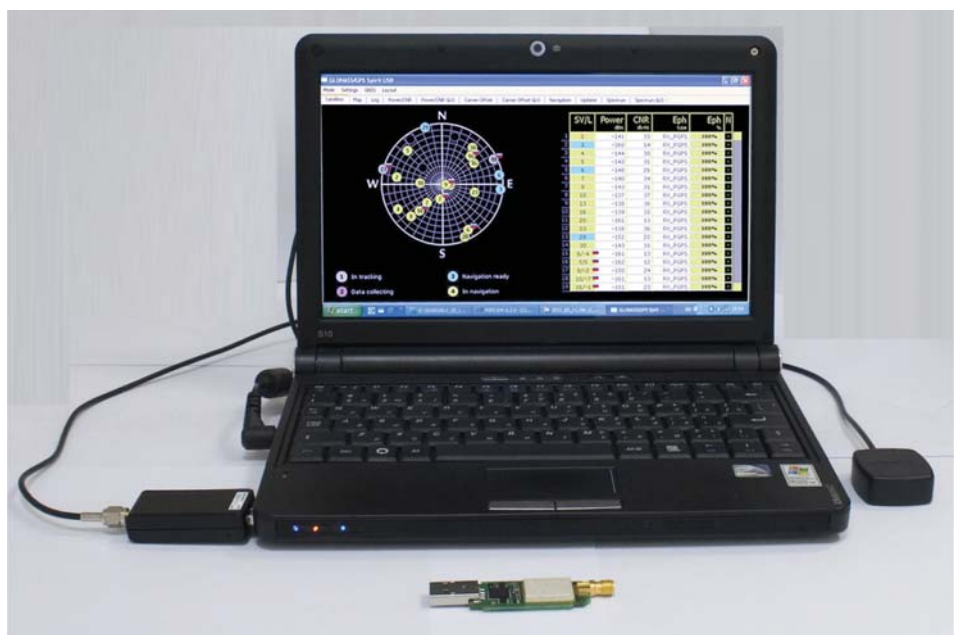
Рис.3. Сверхчувствительный программный приемник (к USB-порту подключен G3-донгл в корпусе и антенна; на переднем плане рядом с нетбуком показан G3-донгл без корпуса; в левой части монитора нетбука на круговой диаграмме показаны в желтых кружках видимые спутники GPS, а в кружках с флажками РФ — видимые спутники ГЛОНАСС; в правой части монитора в таблице представлена информация о радиосигналах, принимаемых со спутников
