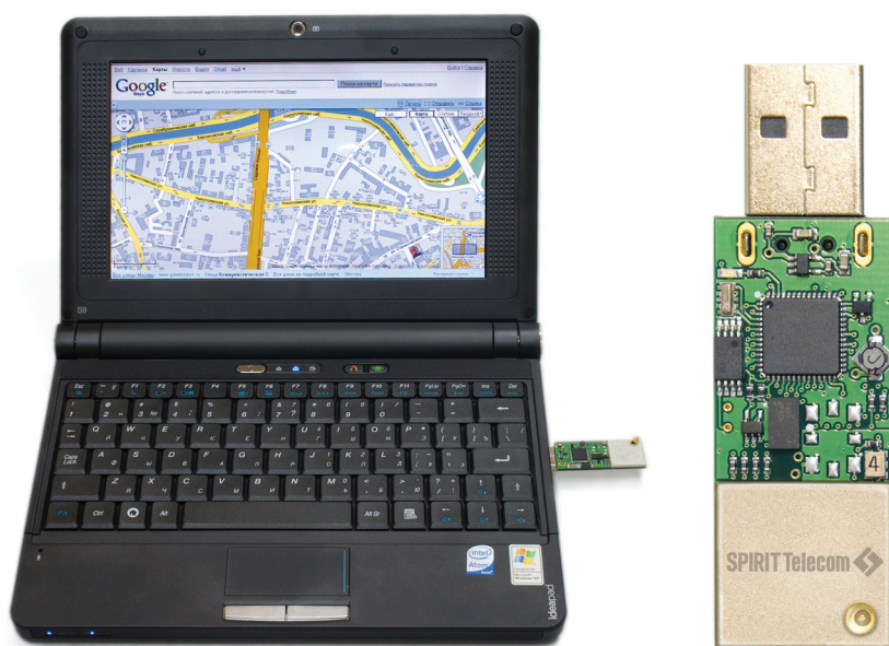
Рис. 2 Общий вид приёмника на базе нетбука и USB-донгла (а) и USB-донгл (б)
